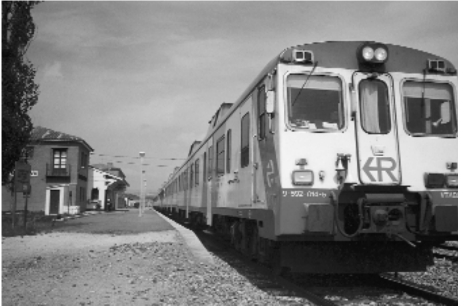
En Calamocha tienen parada todos los trenes Teruel-Zaragoza, servidos por automotores diesel de la serie 592, como el de la fotografía.
